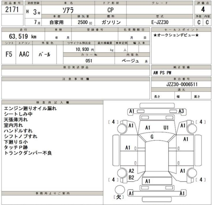
A:キズ U:ヘコミ B:キズを伴うヘコミ P:要塗装 W:補修跡 S:錆 C:腐食 G:フロントガラス点キズ XX:交換済み X:要交換 内・外装評価 5段階ランク順(A・B・C・D・E)
