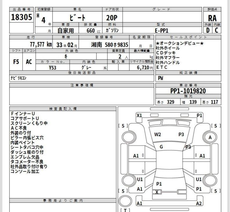
A:キズ U:ヘコミ B:キズを伴うヘコミ P:要塗装 W:補修跡 S:錆 C:腐食 G:フロントガラス点キズ XX:交換済み X:要交換 内・外装評価 5段階ランク順(A・B・C・D・E) 2
